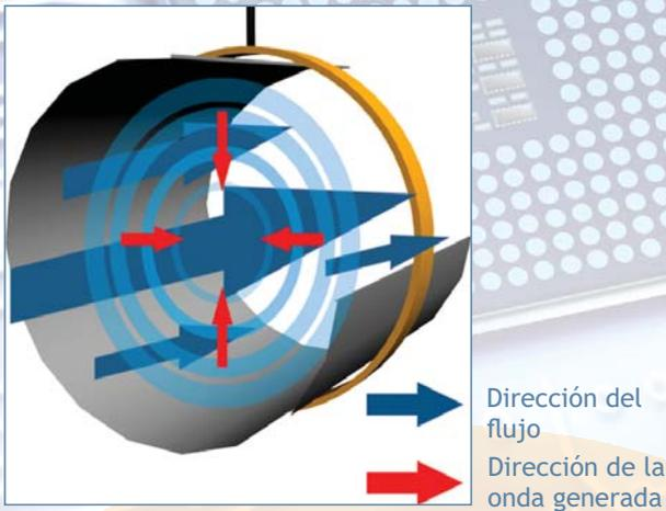
La intervención de IONCAL consta de unos impulsos electrónicos que van dirigidos directamente al centro del agua en las tuberías y que efectúa mediante una transferencia capacitiva de energía, excluyendo por tanto cualquier fenómeno de electrólisis.
