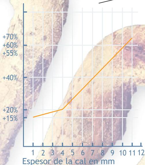
El espesor de las incrustaciones calcáreas representa importantes pérdidas de energía, ya que estas actúan como aislante térmico.
